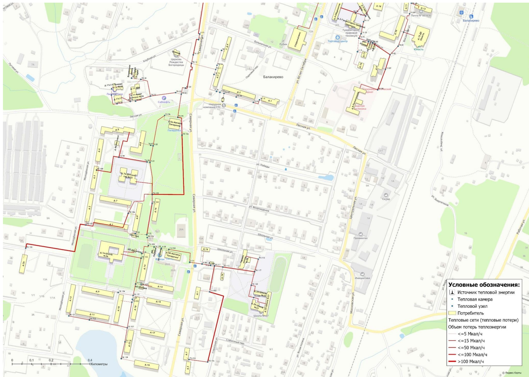
Рисунок 3.7.2 - Потери тепловой энергии при её передаче по участкам тепловых сетей поселка Балакирево (южная часть)
