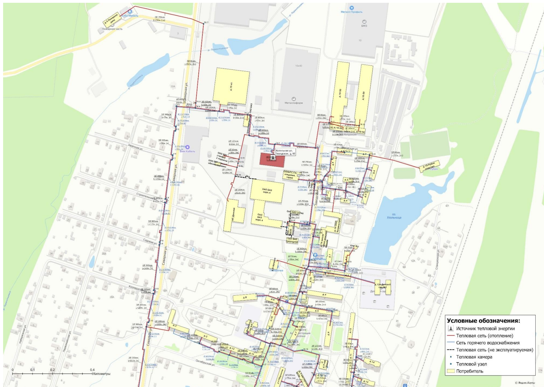
Рисунок 1.3.2.1 - Схема тепловых сетей котельной пос. Балакирево (северная часть)
