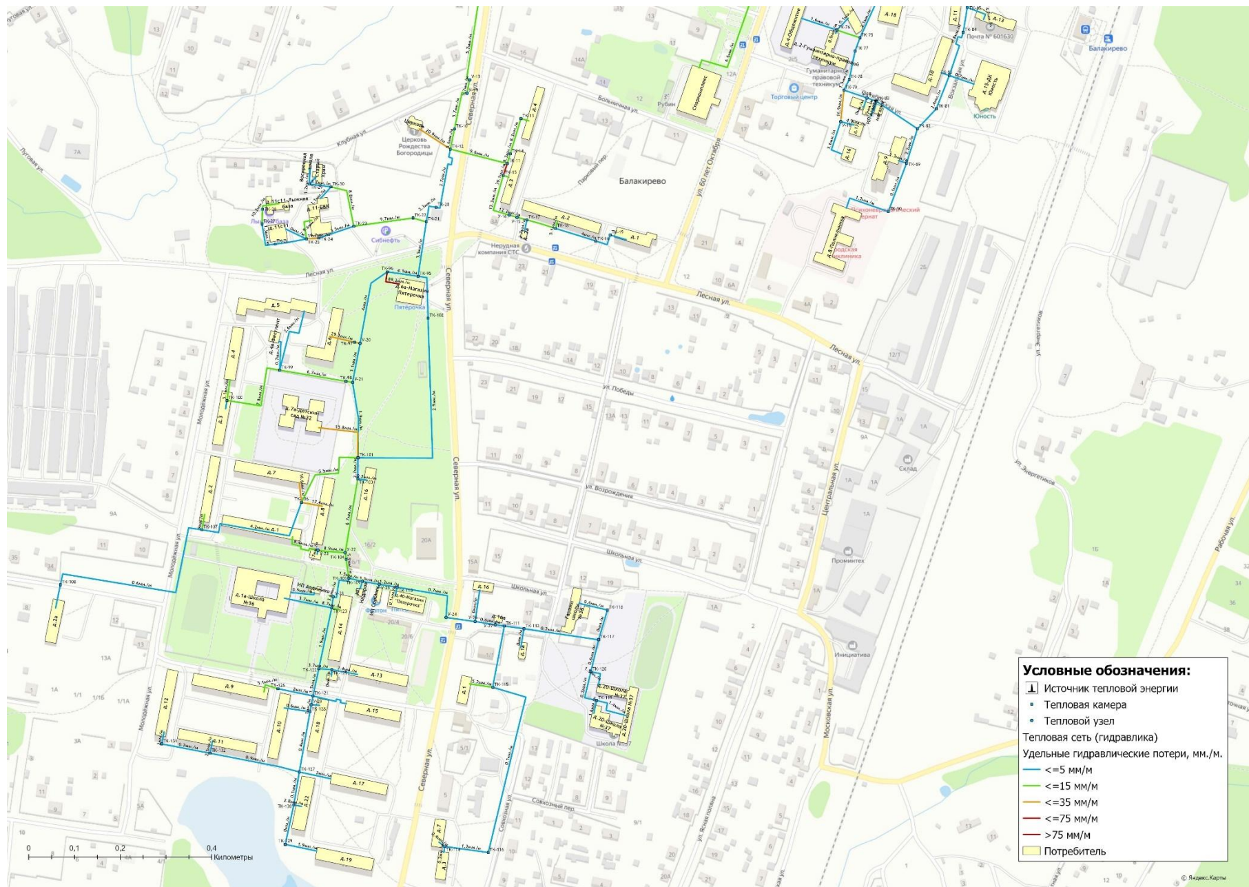
Рисунок 3.4.2 - Гидравлические расчеты участков тепловой сети котельной пос. Балакирево (южная часть)
