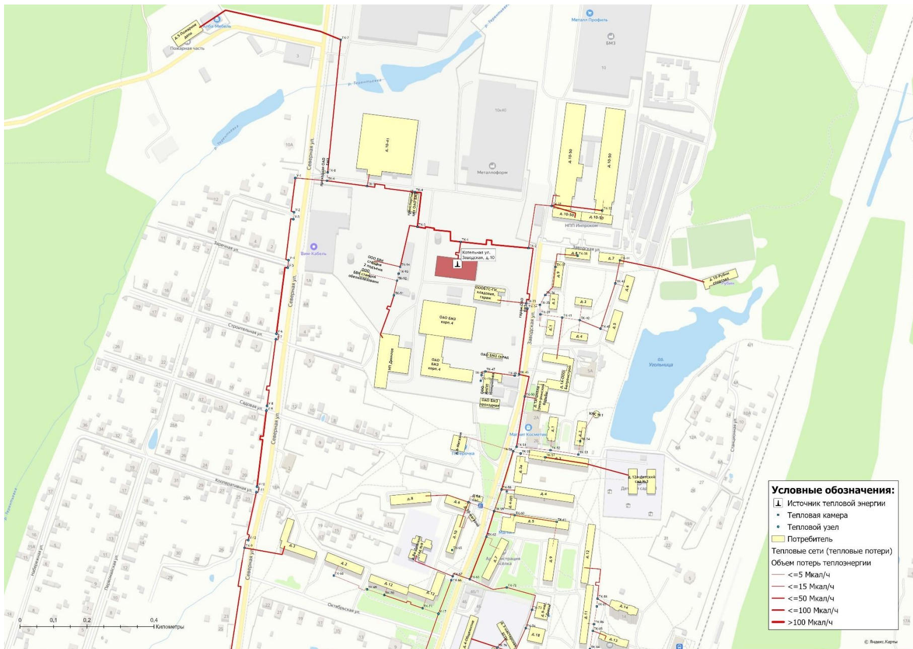
Рисунок 3.7.1 - Потери тепловой энергии при её передаче по участкам тепловых сетей поселка Балакирево (северная часть)
