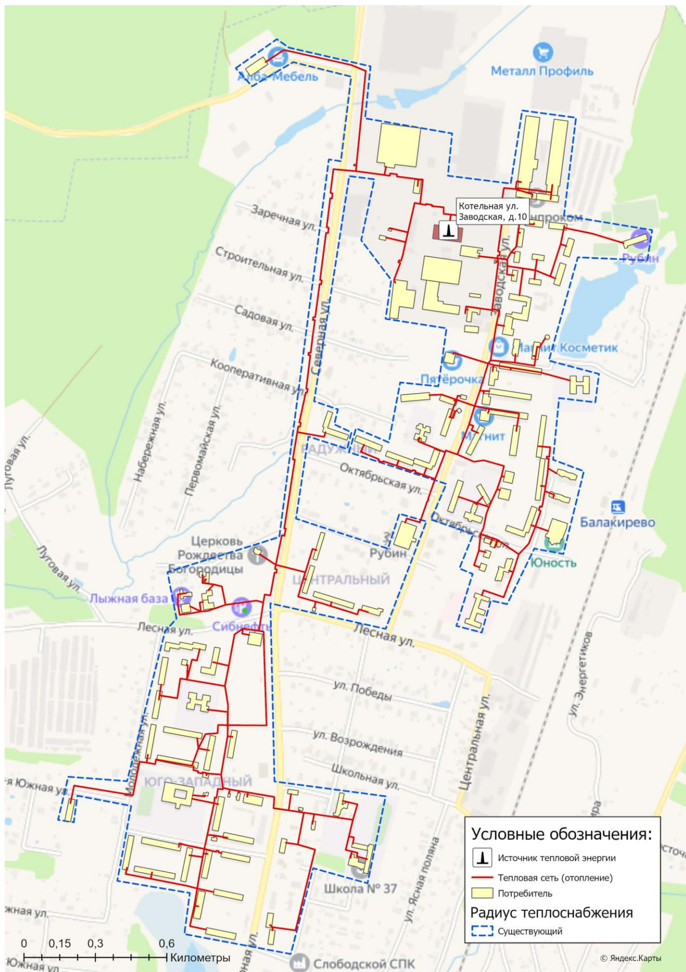
Рисунок 7.15.1 - Радиус теплоснабжения котельной пос. Балакирево (существующий)
